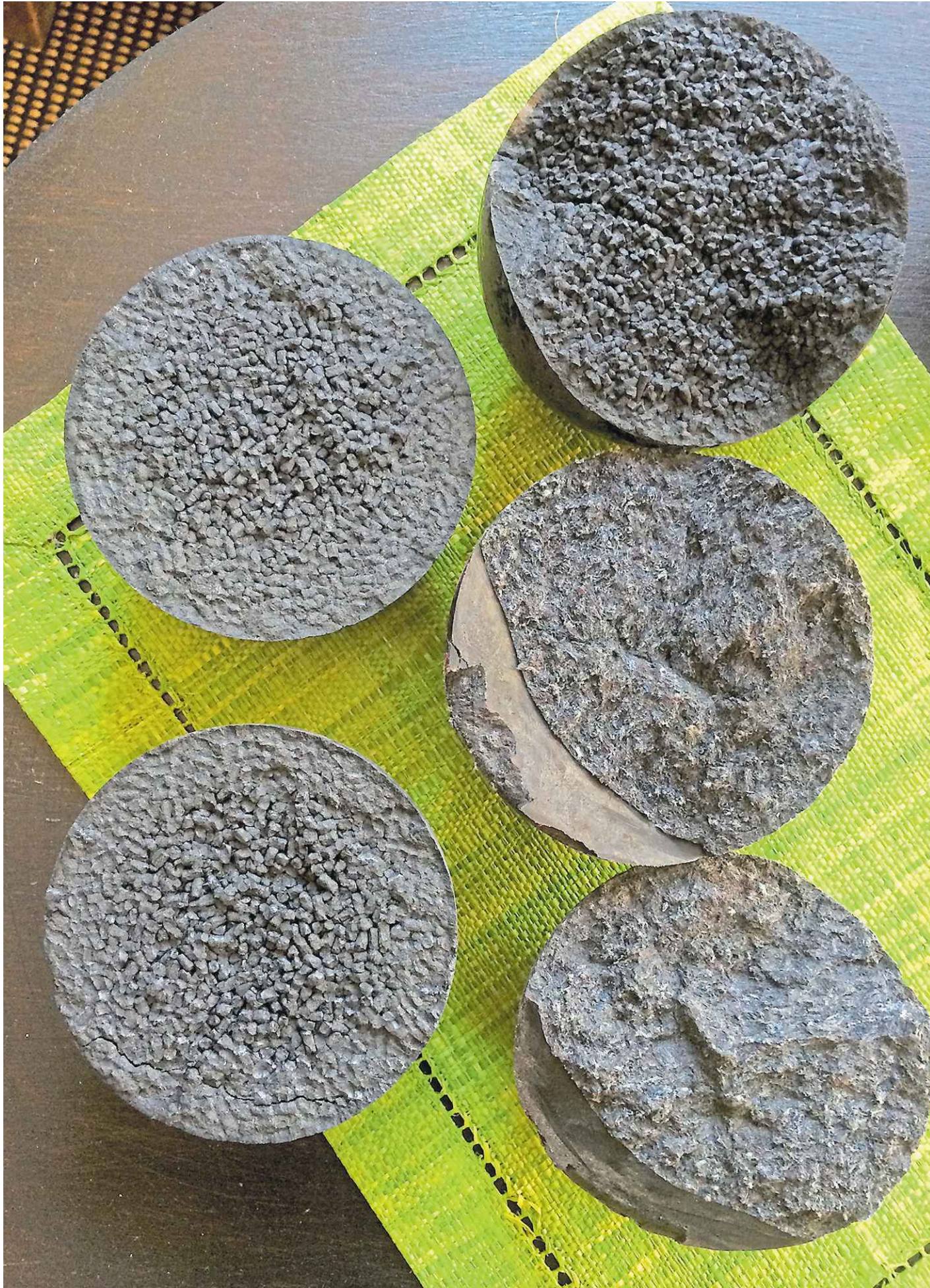
Wenn Kunststoffkugeln nicht mit der richtigen Temperatur und dem richtigen Druck hergestellt werden, verbindet sich das Granulat nicht ausreichend. Daher sind einige Tests notwendig, um die richtigen Parameter zu ermitteln. BILD: PRIVAT
